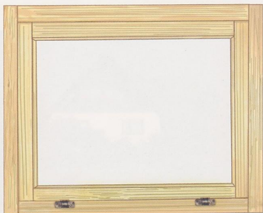
内倒し排煙窓
